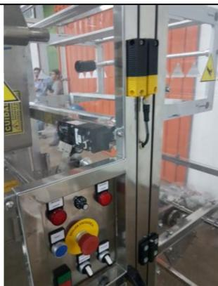
**IMAGENS: SENSOR RFID, BOTOEIRA DE EMERGÊNCIA,
